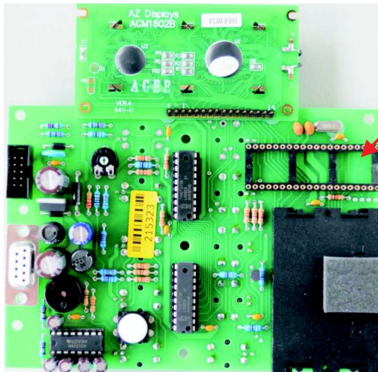
den Baustein leicht anhebeln und auf die neue Tastatur passgenau einsetzen.
